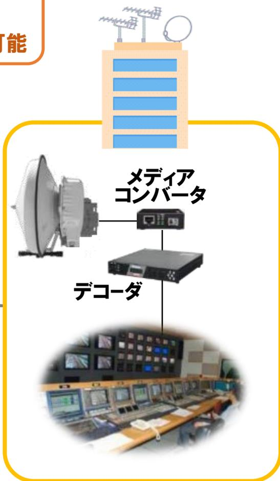
80GHz高速無線装置はリーズナブルな価格で設置できますので離島や山間部等のデジタルディバイド解消対策に寄与できます。本装置により双方向で1.5Gbpsのインターネット環境が構築できます。
